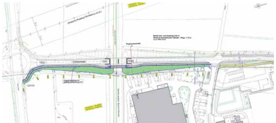
Anbindung über eine Einfeldbrücke in Stahlbauweise
